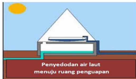
Air Laut disedot dengan pompa
